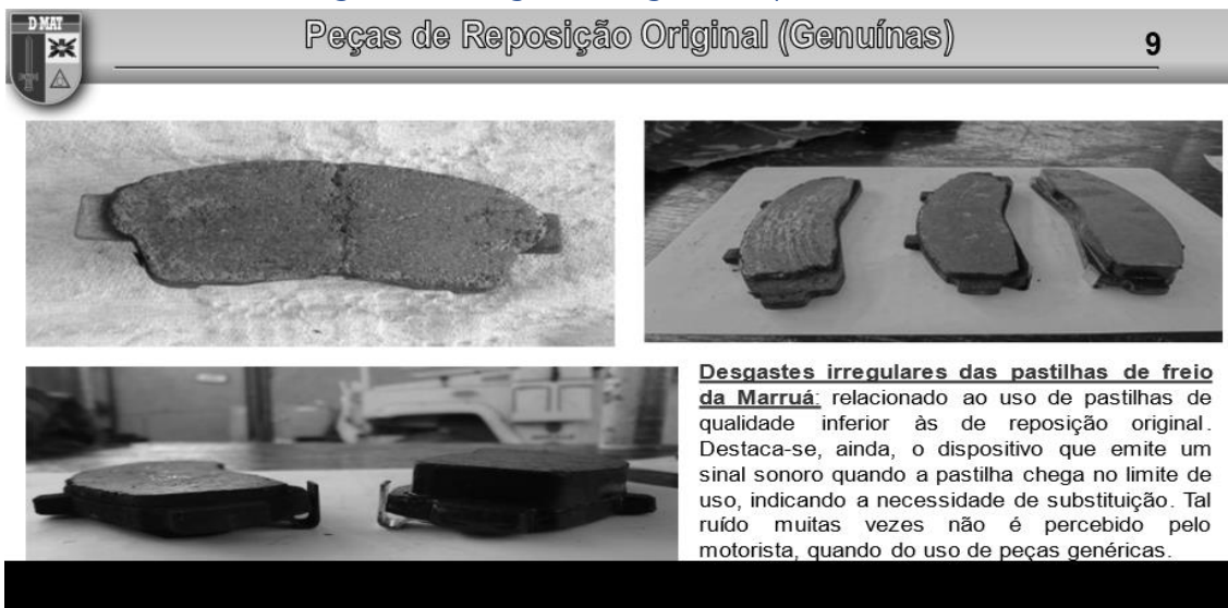
Figura 6 - Desgaste irregular de pastilhas de freio
