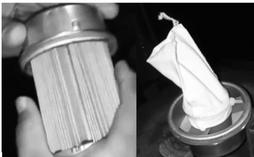
Figura 5 - Filtro de Reposição Original (esquerda) X Filtro de Origem Duvidosa (direita)
